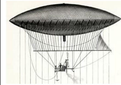
1852 : l'aérostat avec moteur à vapeur. Vol de 37 km
